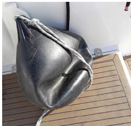
Zniszczony odbijacz typu gruszka.
